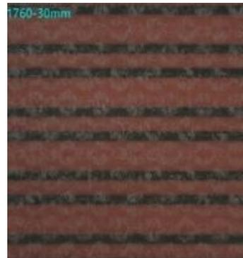
弯折测试后，目视检查未发现基材表面有折断或裂纹迹象。
